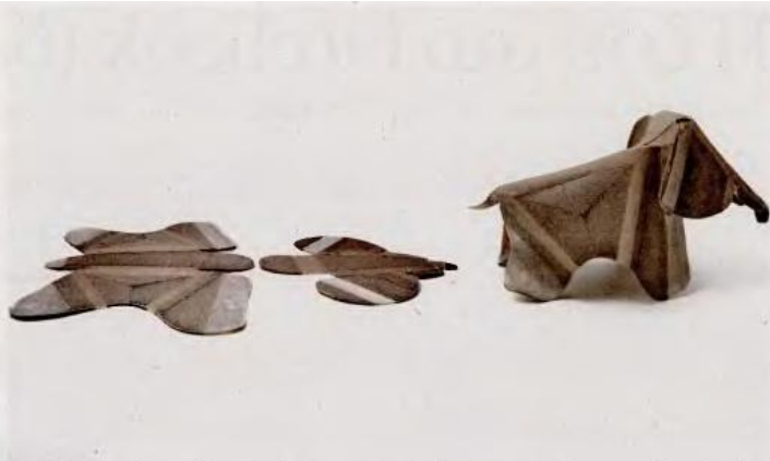
Πολυβρόνα και καλάκια από εξημένα υλικά που αυτοσυαρμολογούνται. Με μια καινοτόμο εφαρμογή που δημιουργήσε το εργαστήριο του MIT, υλικά έχουν ρυθμιστεί να τροποποιούν υπό συνθήκες τη λειτουργία τους.
